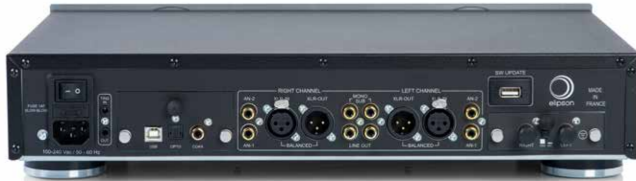
Vue arrière avec carte phono et carte numérique (DAC) Rear panel view with phono circuitry and digital circuitry (DAC)
