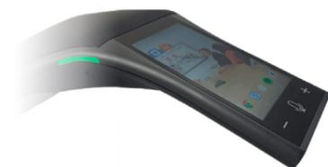
Terminal de comunicaciones universal con sonido HD, cancelación de eco y 3 micrófonos digitales. Pantalla táctil FullHD con control de micrófono y volumen. Conexión USB y HDMI a cámara y monitor, para uso en videoconferencias: USB para ser micrófono y altavoz sobre PC y Mac; WiFi 2,4 y 5 Ghz. y Ethernet.
